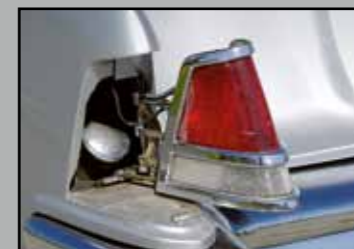
Zajímavá hříčka: tankovací hrdlo za výklopnou levou zadní svítlinou
