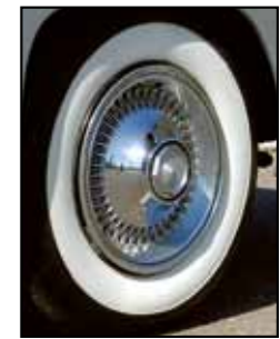
Původní ocelové ráfky 6,5 x 15" dostaly nové obutí Coker Whitewall
