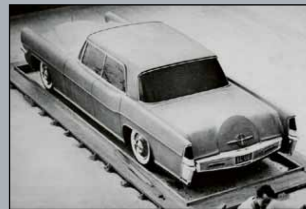
Hliněný model čtyřveřové Berlíny v surovém stavu a pak upravený do podoby skutečného auta
