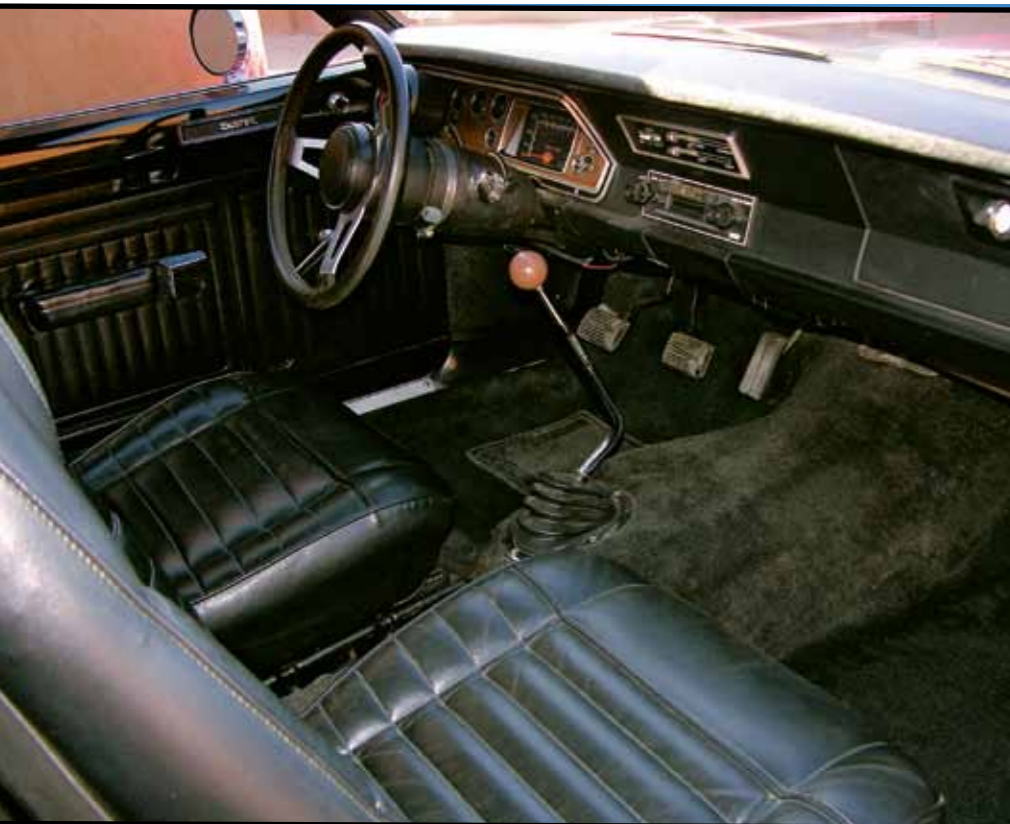
Duster 340 měl v sérii třístupňovou manuální převodovku. Náš kousek je však vybaven příplatkovým čtyřkvátem
