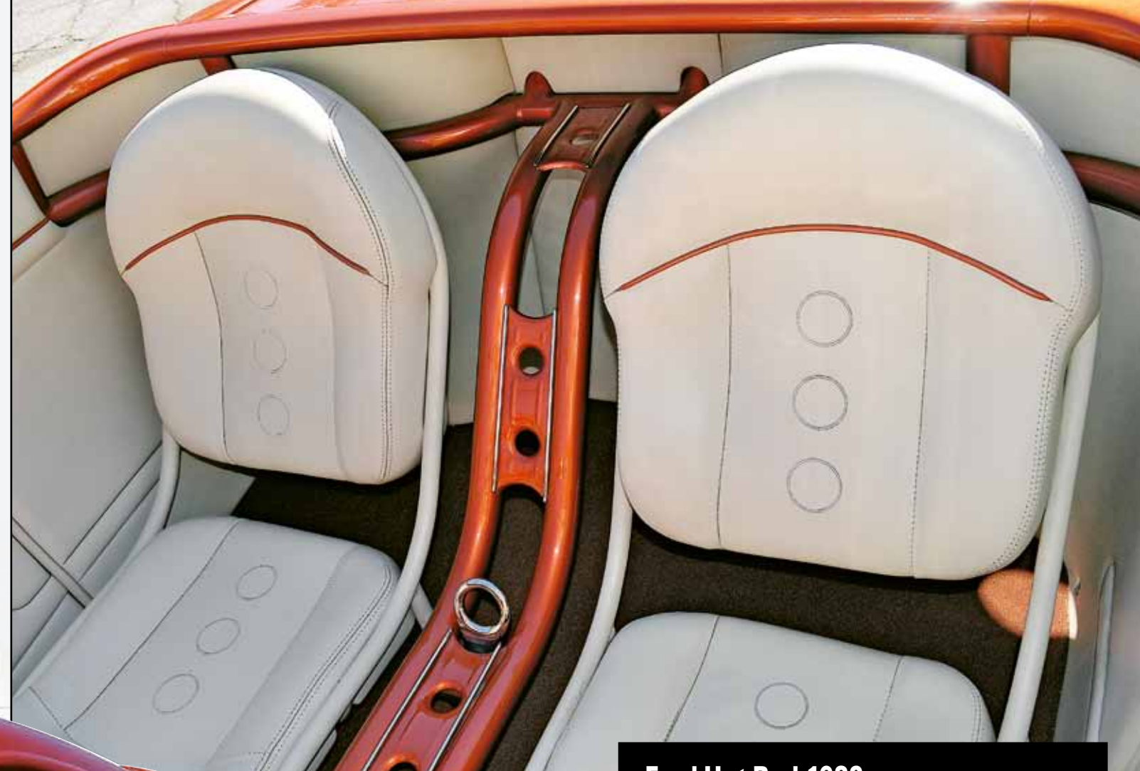
Základ k sedačkám našel Troy ve Volvu '58, trubková střední konzole slouží k zesílení
