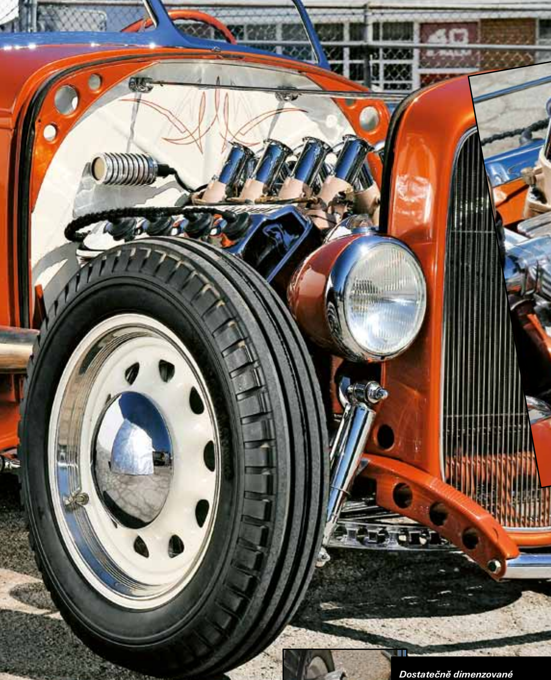
Ráfky pocházejí z Dodge '34 a jsou navařené na vnitřní děrovanou část disků Chevy
