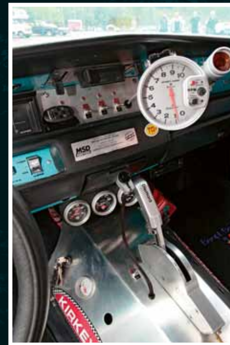
That's racing! Otáčkoměr Auto Meter s kontrolkou pro přeřazení
