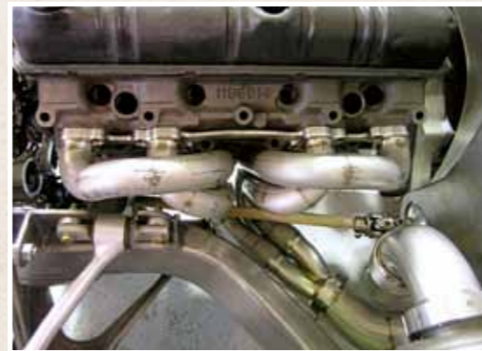
Zakončení komplikovaných svodů svařených ze samostatných dílců tvoří frézované příruby
