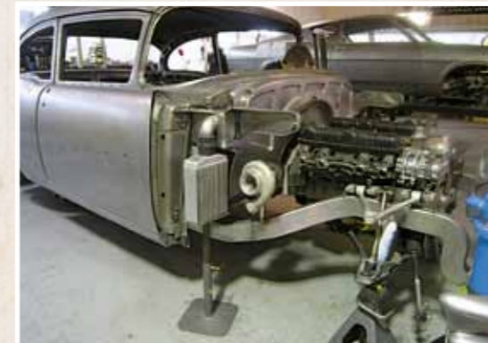
V zadní partii blatníků za podběhy jsou uložena dvě turbodmychadla, mocně dopující všech 423 kubických palců motoru Nailhead
