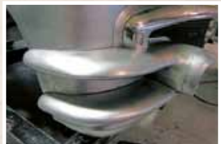
Spousty detailních úprav od Rad Rides si člověk všimne až na druhý pohled, jako třeba zkrácených „kornoutů“ na nárazníku
