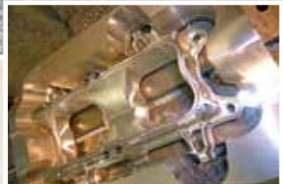
Při stavbě Buicka musela CNC fréza dělat přesčas. Na fotce právě vzniká adaptér pro vstříkovaní do sacího traktu
