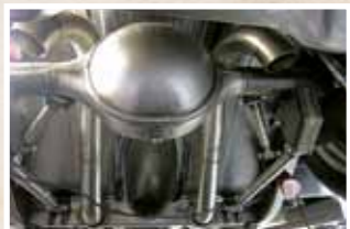
Rám Art Morrison byl již připraven pojmout 9" zadní osu Ford spolu se zavěšením na čtyřech ramenech
