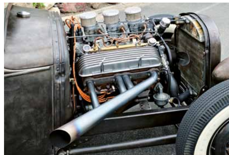
Chevy 283 cu.i. má ještě původní odvětrání klikové skříně
