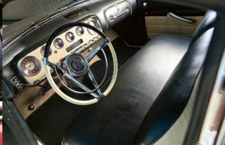
Čalouněná přístrojová deska byla tehdy velkou neznámou. Majitelé lupy nebo dobrého zraku rozeznají páčku voliče automaticky vlevo vedle volantu
