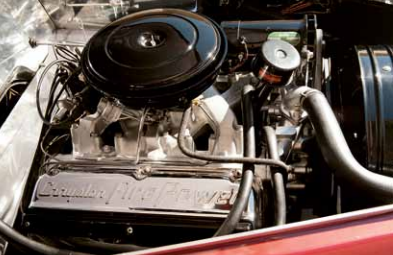
Pod kapotou je opravdový V8 Hemi, i když to na fotce nevypadá. Jedná se o silnější dodatečně montovanou verzi z roku 1956 o výkonu 280 koní
