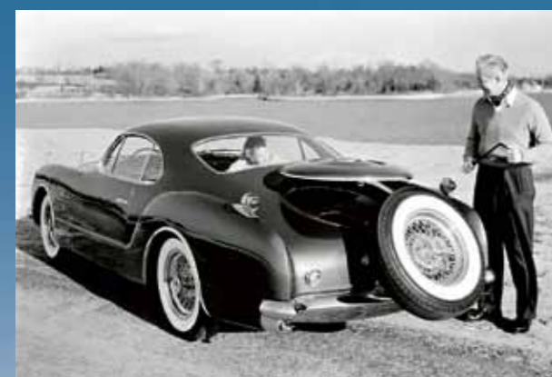
Zavazadlový prostor byl přístupný zevnitř vozu. Pod kulatým krytem čekalo výklopné rezervní kolo a hever s nářadím
