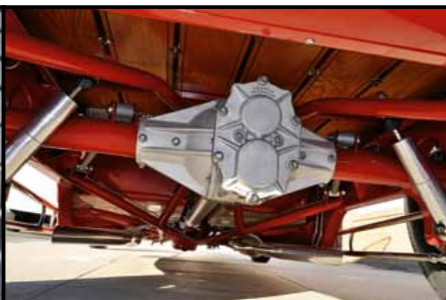
Náprava Quick Change s proměnlivým převodem byla především závodním doplňkem
