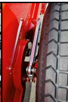
Páková ramena spojují nápravy s pružícími zkrutnými tyčemi
