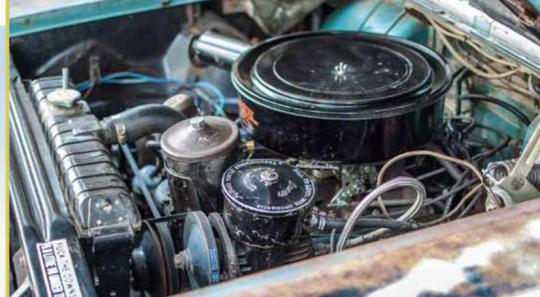
Pod kapotou duní původní šestilitrový osmiválec, vše zůstalo na svém místě kromě kompresoru vzduchového podvozku
