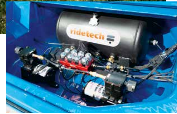
Pod podlahou v zavazadelníku nainstaloval Frank s pomocí kamaráda potřebné kompresory, zásobník a ventily pneumatického podvozku Ridetech
