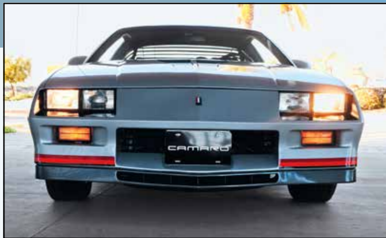
Přední a zadní spoiler Z/28 přináší ve srovnání se základním modelem v rychlosti 55 mph bezmála o 240 Pa větší přítlak, na zadí je tato hodnota více než dvojnásobná
