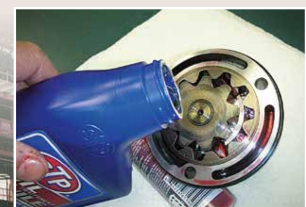
Před montáží olejového čerpadla STP doporučuje naplnit jej viskózním přípravkem
