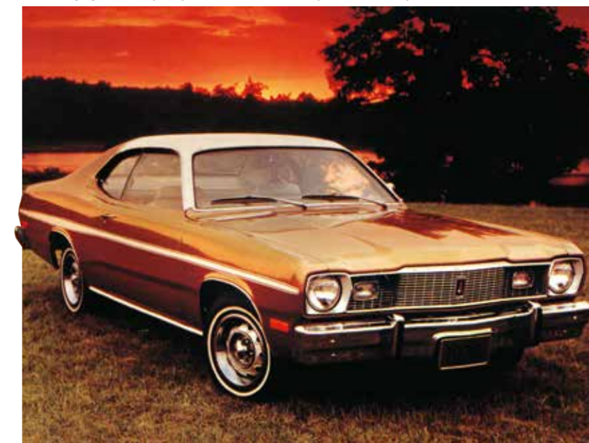
Duster 360 přinesl v roce 1975 nové a výrazné boční pruhy. Pod kapotou pracoval V8 360 cu.i. se čtyřkomorovým karburátorem a jmenovitým výkonem 230 koní
