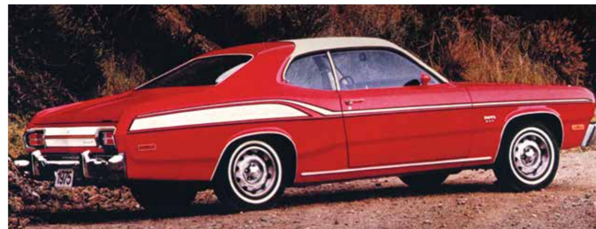
Duster 360 přinesl v roce 1975 nové a výrazné boční pruhy. Pod kapotou pracoval V8 360 cu.i. se čtyřkomorovým karburátorem a jmenovitým výkonem 230 koní
