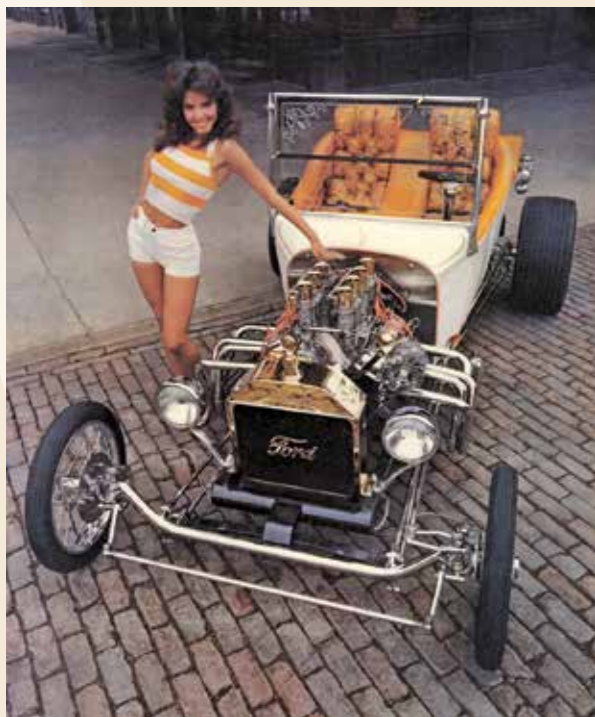
T-Bucket na snímku pochází z Texasu, pohání jej véosmíčka Chevrolet 327 cu.i., zdobí pravý mosazný chladič a ke zpomalení používá přední kotoučové brzdy
