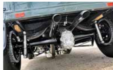
Příčné listové odpružení je přizpůsobené zadní nápravě Winters Quick Change. Na snímku i duální výfuky...
