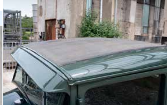
Po snížení bylo nutné střechu znovu nalakovat, ale protisluneční štít a střešní vinyl pocházejí z roku 1931
