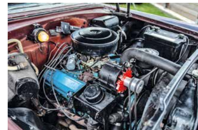
Underhood trouble lamp si posvítil na původní motor se čtyřbarelovým karburátorem Carter. Moderní alternátor jednoho dne nahradí původní generátor
