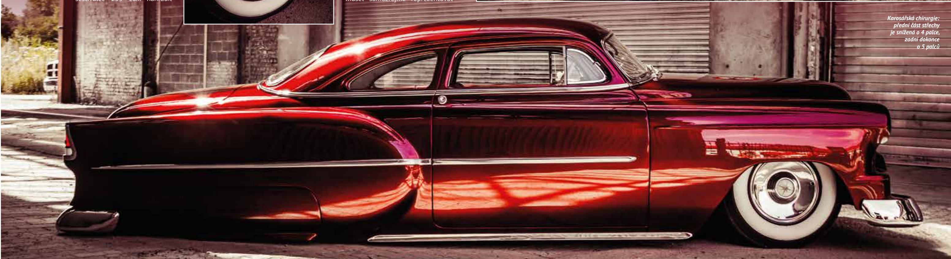
Frenching (hlubší vsazení reflektorů) odstranil chromované rámečky světlometů a nechal zazářit předí jako celek
