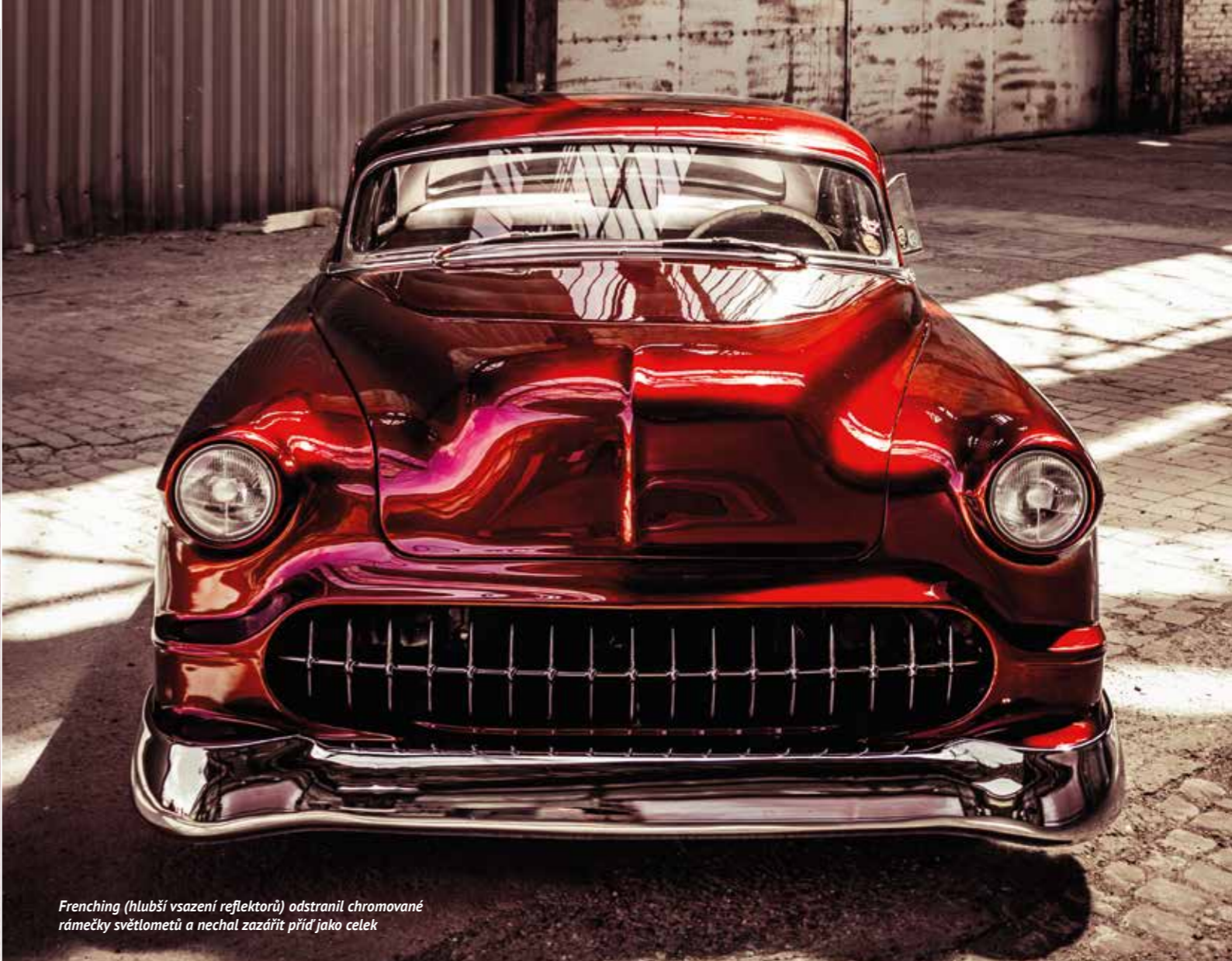
Karosářská chirurgie: přední část střechy je snížena o 4 palce, zadní dokonce o 5 palců
