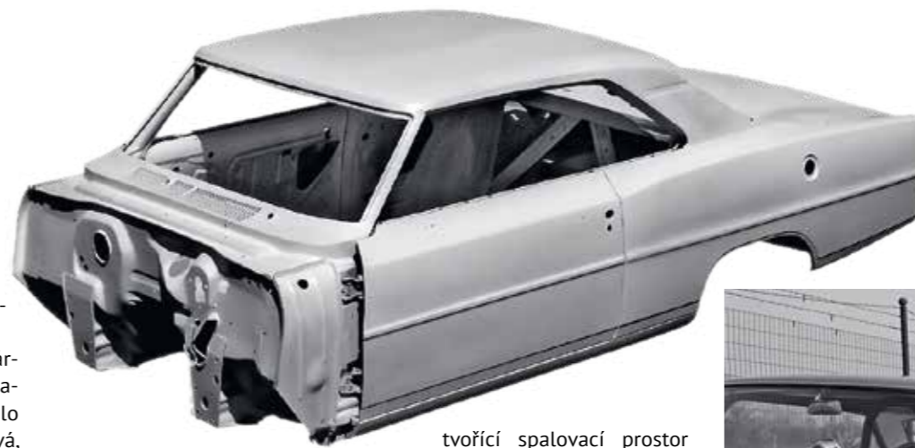
Chevy II měl polosamonosnou karosérii, přední část byla přišroubovaná na příčnou stěnu
