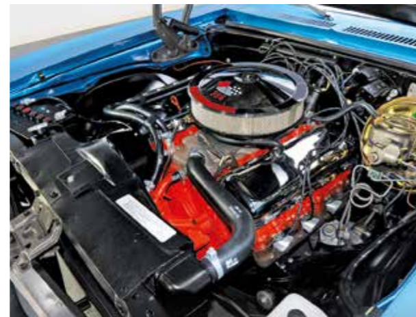
Big-block pod kapotou Novy slavil premiéru roku 1968, na snímku je 396 cu.i. provedení L78 s výkonem 375 koní
