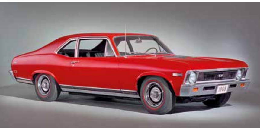
V roce 1968 nesla Nova Super Sport zkratku názvu uprostřed grilu. Model na snímku má příplatkové ráčky Rallye. Ke standardní výbavě Novy SS patřily pneumatiky s červeným proužkem a V8 350 cu.i. s výkonem 295 koní
