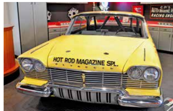
Plymouth Fury ročníku 1957 předvádí tehdejší bezpečnostní prvek: masivní trubkový rám
