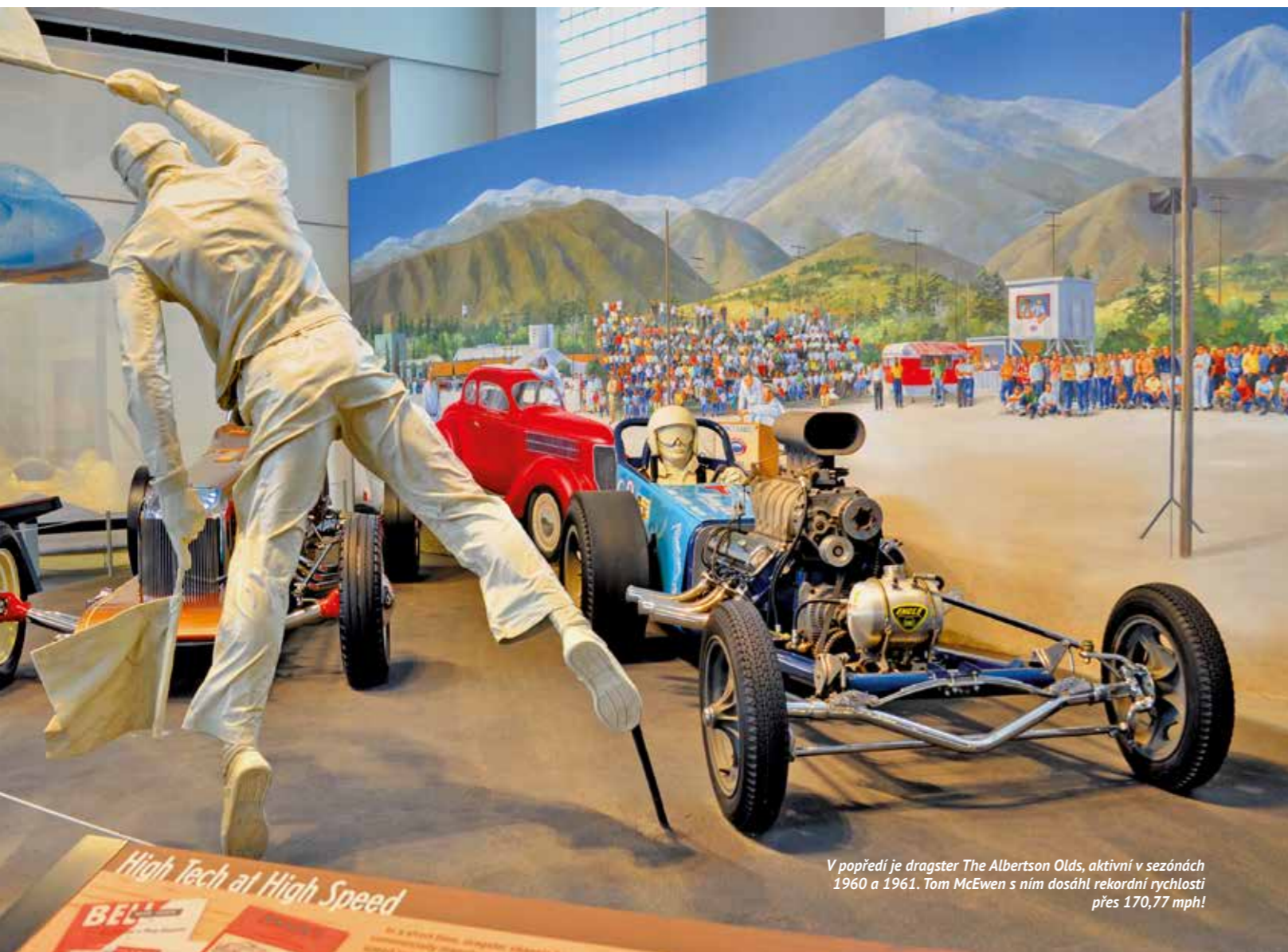
Extra dlouhé stroje představují dobu raných modelů Top Fuel s agregáty Hemi. První podoba měla motor před kokpitem, později se pohonná jednotka přestěhovala mezi jezdce a zadní nápravu
