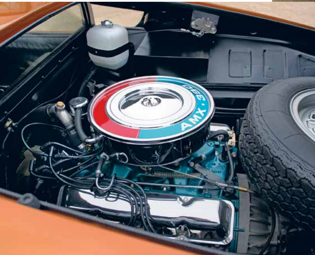
Benzínový osmiválec 390 cu.i. byl skvělou volbou. Agregát je uložen před zadní nápravou, na kterou posílá přes transaxle převodovku 340 koní. Společnost mu dělá náhradní kolo, které se už nikam nevešlo
