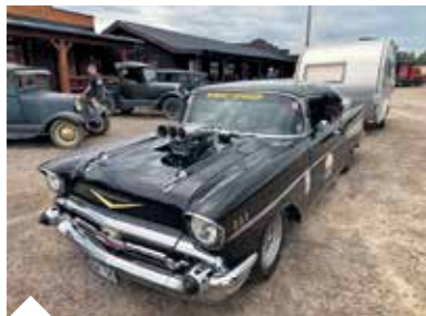
Chevy 1957 s big-blockem dopovaným kompresorem a brutálním zvukem
