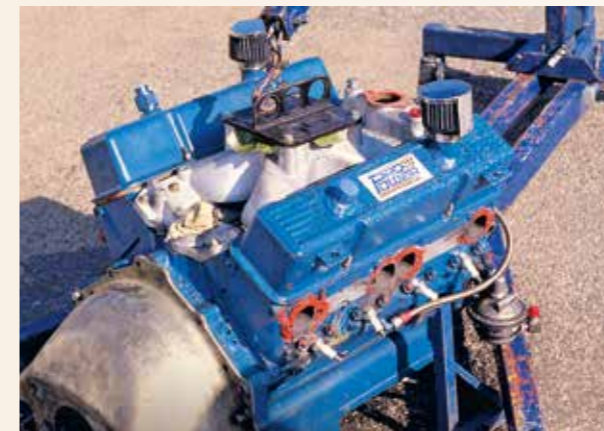
Small-block Chevrolet zaujme svičkami, které nemají obvyklou polohu, známou ze sériových agregátů
