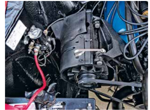
Pod kapotou prvního modelového ročníku najdeme ještě stejnosměrný zdroj elektřiny
