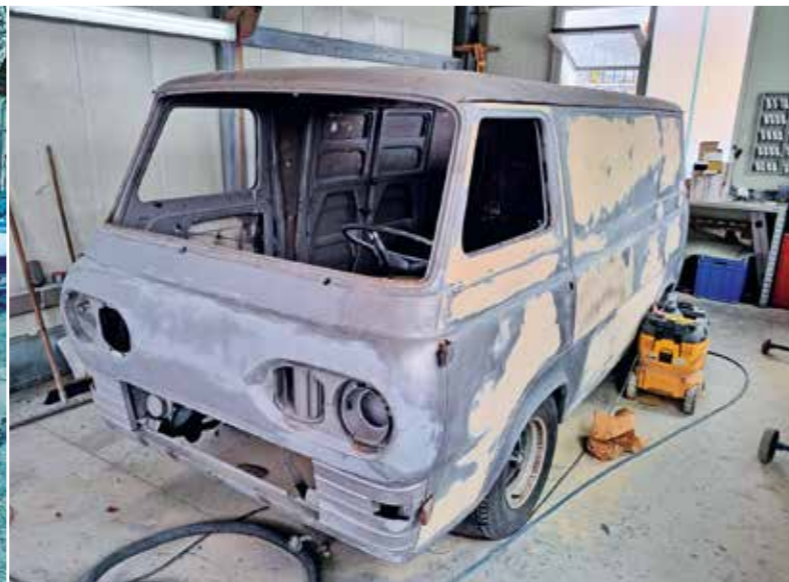
Příprava pod lak jde vždycky až na holý kov. O postupu prací referovala stanice RTL Nitro
