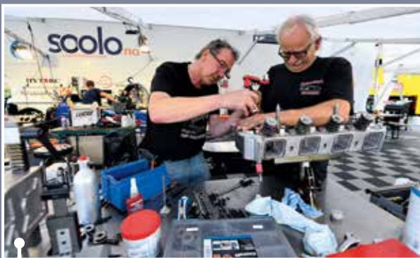
Správně sestavené hlavy jsou jednou z mnoha věcí, na kterých záleží spolehlivý chod motoru, který generuje přes 11.000 koní. Mechanici usilovně pracovali na dragsteru Linn Fløysvik, jež byla jednou ze tří dam startujících v kategorii Top Fuel Dragster
