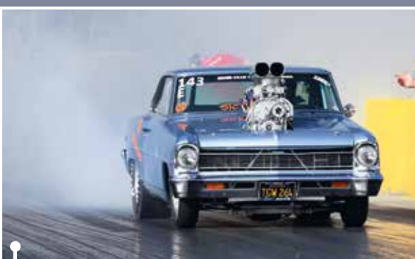
Velká paráda v podobě spousty eloxu a leštěného duralu s kompresorem tak velkým, že sání koukalo nad střechu. Chevrolet Nova '66 má motor 572 cu.i. Scott Shafiroff s hlavami Dart II přeplňovaný kompresorem BDS, a dvoustupňovou převodovku Power Glide
