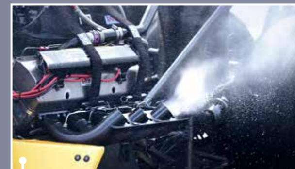
Nespálený nitromethan létající z výfuku byl právě tou příčinou, proč Susanne Callin nezvládla první kolo vyřazovacích jízd. Nedokonalé spalování může být velkým problémem, v některých případech končícím destrukcí motoru. Kapalina je nestlačitelná a paliva je do motoru tlačeno velké množství
