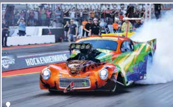
Stian Rusanen nepálil pneumatiky jen tak divákům pro radost. Burn out je velice důležitá součást předstartovní procedury, při které se gumy očistí, zahřejí a závodník si připraví stopu pro následující start. Oblak dýmu je efektní a diváky velmi žádán
